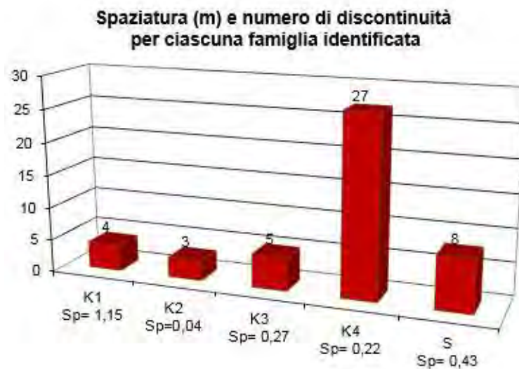
Fig. 4.14. Valori in metri della spaziatura per ciascuna famiglia di discontinuità identificata
